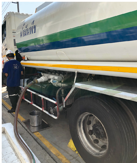
廃油を回収するタンクローリー
